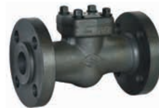
Van 1 chiều hơi thép rèn A105 nối bích ANSI Class 150 Forged Steel A105 Lift Check Valve Flanged Ends ANSI Class 150 DN15A - DN50A
