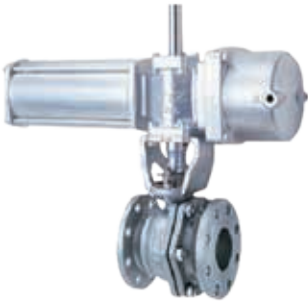
Van bi inox 304 nối bích ANSI 150 điều khiển khí nén 1 chiều Model BS-150UTB Pneumatic Stainless Steel Ball Valve Flanged Ends ANSI Class 150 Single Acting DN15-DN250
