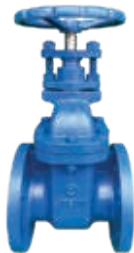
Van cửa ty chìm gang đúc nối bích DIN PN16 RF Cast Iron Gate Valve Non-Rising Stem Flanged Ends DIN PN16 RF DN50A - DN300A
